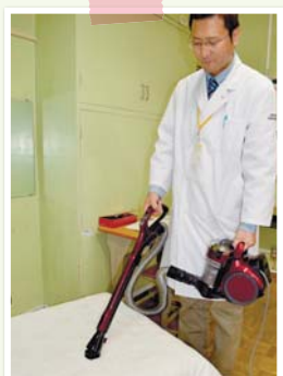
▲ 保健室のベッドにダニがどれだけいるか、一定の面積を掃除機で吸い取って検査します
